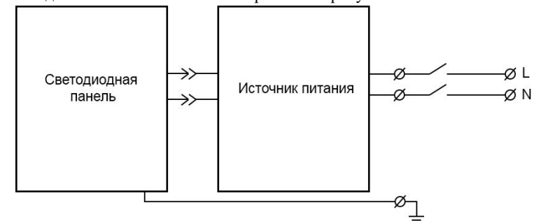
Рисунок 3 Схема подключения светильника
